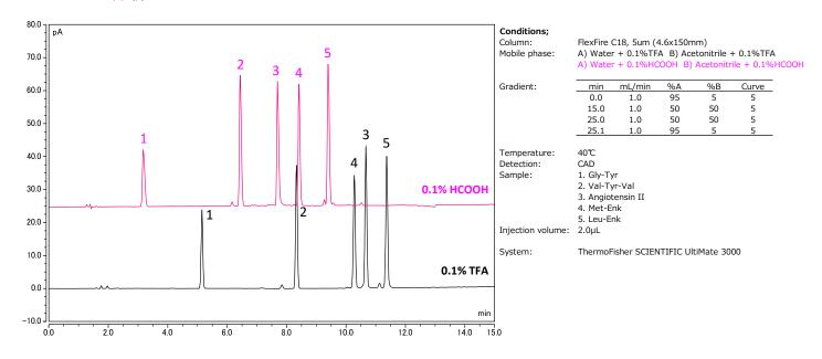
従来よりイオンペア試薬で分析してきた条件をギ酸に置き換えて分析できる可能性があります。特に、LC/MSではTFAの使用が制限されることがあるため、ギ酸をファーストメソッドに選択することで感度低減のリスクを回避することができます。
